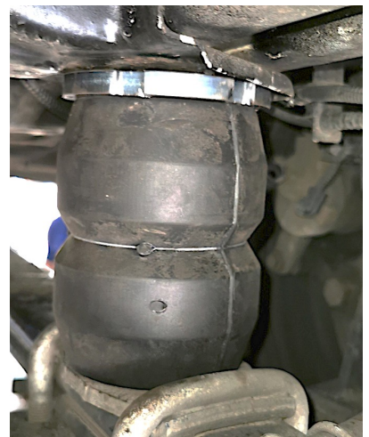
Beszerelt segédrugó (A hézag terheletlen állapotban kb. 5 mm)
