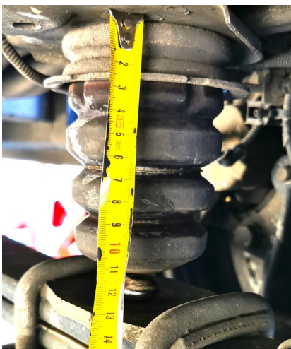
Terheletlen állapotban mért távolság: 140 mm
