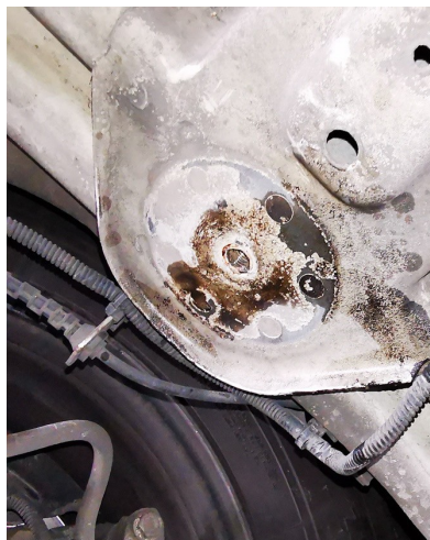
Felfekvási felület a gyári gumibak rögzítőcsészéjének leszerelése után
